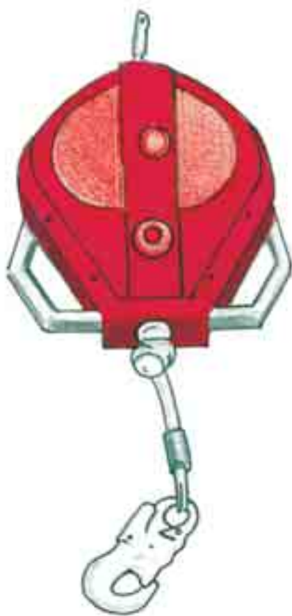
Fig. 9 - Dispositivo anticaduta retrattile
